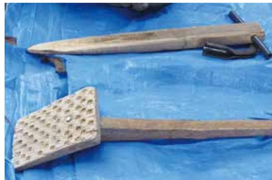
上は縄をかけるため茅を分ける「クサビ」。突き刺してひねることで隙間を作る。下は「コテ」。茅を打ち込んだり、たたいて平らにならす。職人が手作りする
